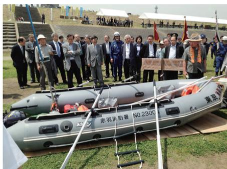
6人乗りの救命ボート。空気ポンプを使って数分程度で出動準備が完了する。
